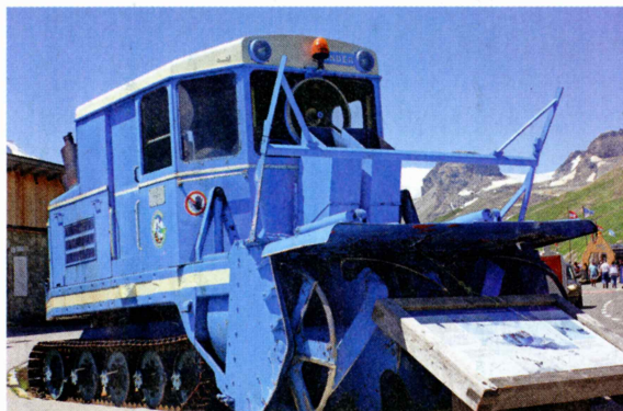
Od leta 1953 cesto čistijo z rotirajočimi plugi, izdelanimi po Wallackovih načrtih, za kar potrebujejo v povprečju tri tedne. Na sliki eden izmed Wallackovih plugov, ki danes ne deluje več.
